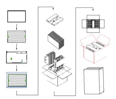
Max capacity: 11 TFT-LCD module per carton
